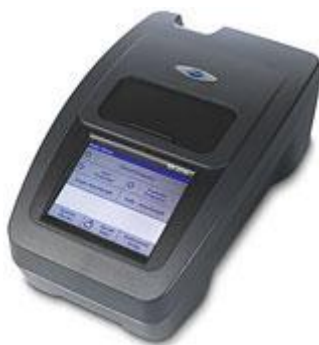
Figura 3– Equipamento Hach dr2700 spectrophotometer utilizado para as análises de sólidos em suspensão do ribeirão Piava de Umuarama-PR.
